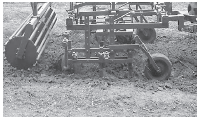
MTCS : machine de technique culturale simplifiée.
