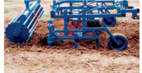
MTCS MTCS (machine de technique culturale simplifiée)
